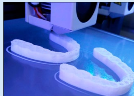
Obr. 2: 3D tlač modelu plánovaného postavenia zubov po liečbe s presnosťou 0,05 mm z PLA
